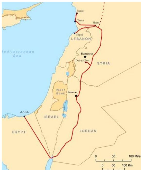
Рис. 7. Арабский газопровод.
